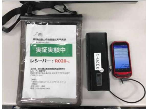
写真 2. 登山道他に設置するレシーバー （ケース、バッテリー、スマートフォン）
